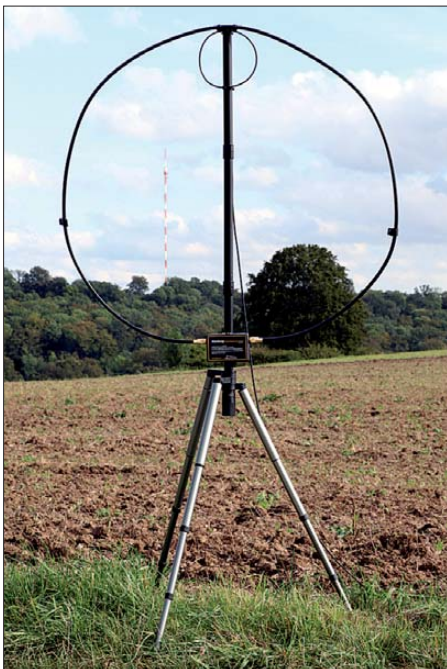
Bild 1: Überall im Handumdrehen einsatzbereit: Die Magnetantenne Alexloop ermöglicht den KW-Betrieb von 7 MHz bis 30 MHz.
