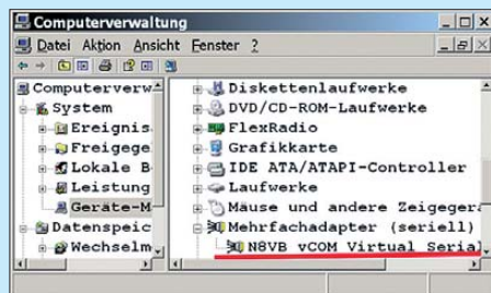
Bild 6: Beispiel für die Anzeige eines virtuellen Ports im Gerätemanager
