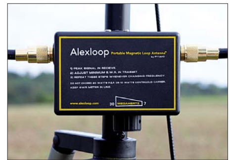
Bild 2: Der Antennenkoppler im Schleifenfußpunkt ermöglicht die manuelle Abstimmung. Dessen Gehäuse ist leicht versetzt auf dem Antennenträger montiert, was den Zugriff auf den Drehknopf insbesondere beim Einhandbetrieb (ohne Stativ) erleichtert. Eine Schraube unterhalb des Kopplers sorgt dafür, dass sich die Antenne leicht auf einem Stativ drehen lässt.
