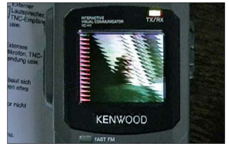
Bild 3: Die nicht genau stimmende SSTV-Taktung führt beim VC-H1 zum Schräglauf.
