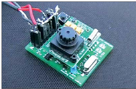
Bild 1: Das SSTVCAM-Modul besteht aus Kamera- und Steuerplatine.
