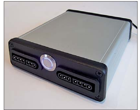
Bild 6: Die EUzebox lässt sich zum Beispiel gut in ein Gehäuse von Hammond einbauen.
