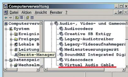
Bild 7: Beispiel für die Anzeige eines virtuellen Audiokabels (VAC) im Gerätemanager
