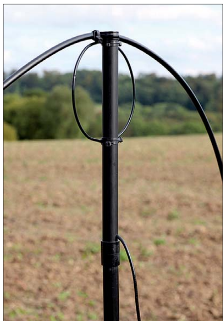
Bild 3: Die Schleife zur induktiven Kopplung ist oben montiert. Das fest installierte Speisekabel läuft zunächst durch das oberste Halterrohr und wird dann nach außen geführt.
