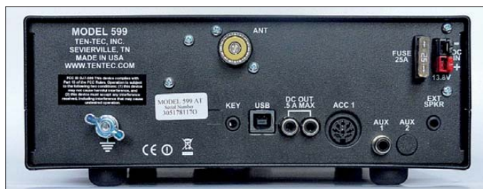
Bild 2: Die Rückfront des Eagle 599 wirkt sehr übersichtlich. Über die USB-Buchse laufen Firmware-Updates und ggf. eine Transceiversteuerung. Neben AUX1 ist noch Platz für eine Erweiterung via AUX2 .
