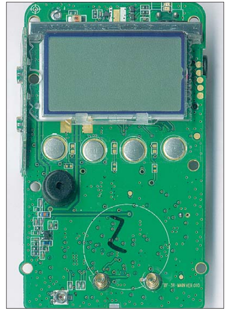
Bild 2: Die Vorderseite der Platine wirkt noch „aufgeräumter“; unter dem Display der µC.
