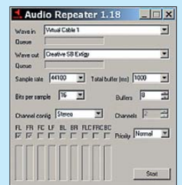
Bild 9: Beispiel für die Einstellung des Audio-Repeater zur Weiterleitung von VAC-Signalen
