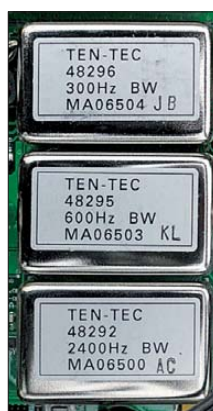
Bild 6: Wesentlichen Anteil an den guten Groß-signaleigenschaften haben diese Roofing-Filter.
