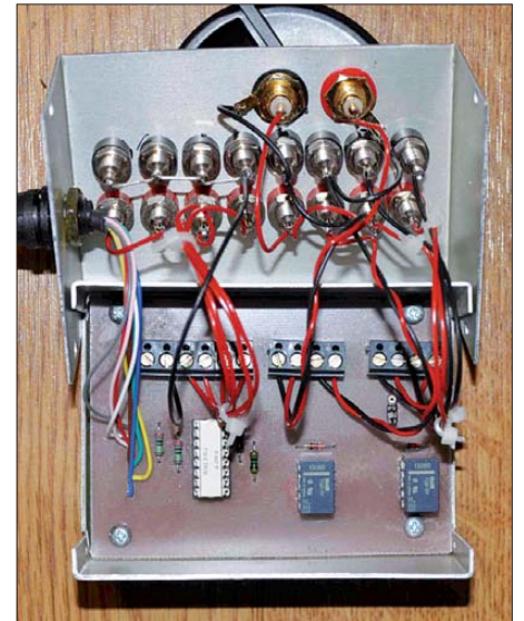
Bild 3: Geöffnetes Adaptergehäuse; unten sind die beiden Relais und der Optokoppler zu sehen, oben links die Kabeleinführung.
