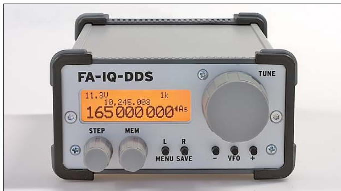
IQ-DDS-Generator nach DL1SNG und DL1FAC
