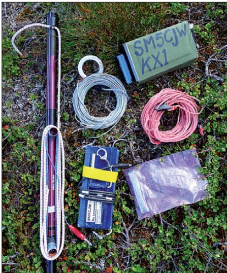
Komplette QRP-Station, fertig zum Einpacken: Transceiver KX1, Antenne nebst Gegengewichten, Solarzelle und Abspannung
