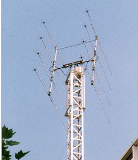
Bild 4: Gruppennyagi 8 x 19 Elemente, gebaut von Harro, DL8VQ, Leo, DJ5VS, und Claus, DL5VJ Fotos: DK4JN
