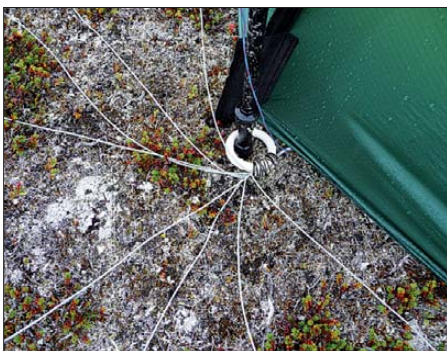
Das Gegengewicht der Antenne besteht aus acht untereinander verbundenen und an einem Gardinenring befestigten kunststoffisolierten 0,5-mm 2 -Kupferdrähten.
